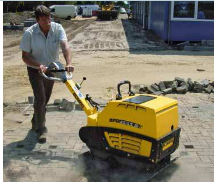
Po wyposażeniu w matę z tworzywa sztucznego (opcja) doskonale nadają się do robót brukarskich.
