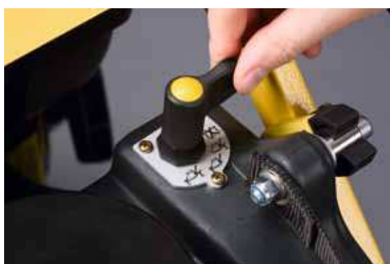
Układ zraszania wodą (opcja): Ilość wody można łatwo i precyzyjnie dozować...
