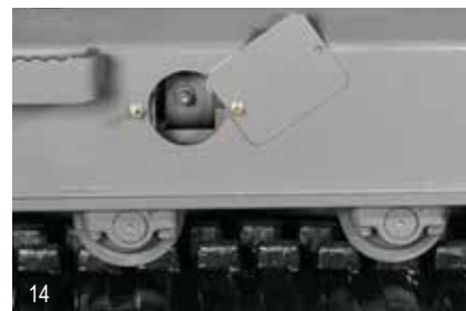
CAŁKOWICIE ZAUTOMATYZOWANE HYDRAULICZNE NAPINANIE GĄSIENIC
