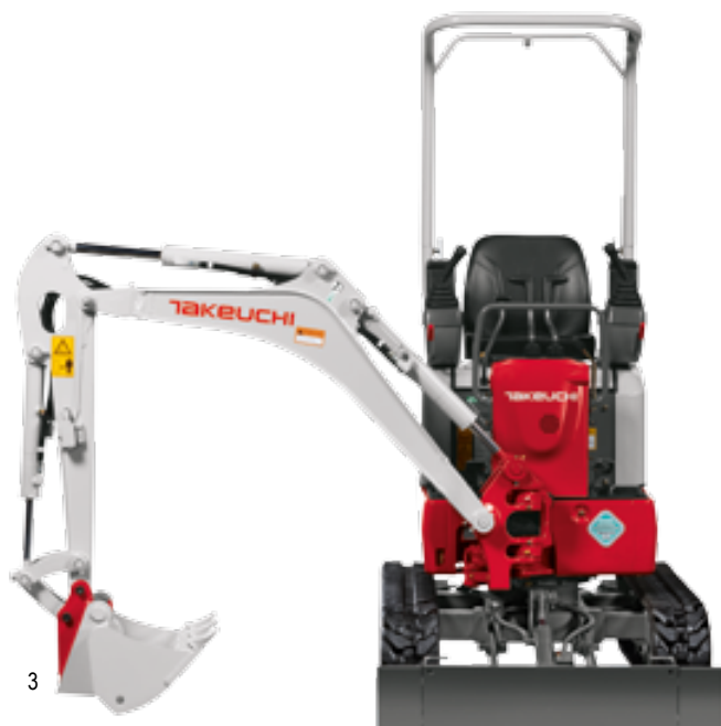
PRZESUNIĘCIE RAMIENIA W PRAWO O 85°
