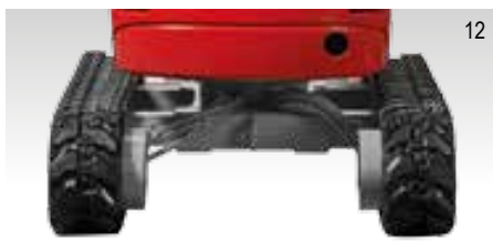
SZEROKOŚĆ PODWOZIA 1.020 MM
