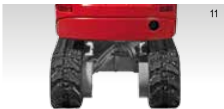
SZEROKOŚĆ PODWOZIA 750 MM
