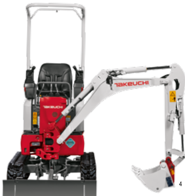
PRZESUNIĘCIE RAMIENIA W LEWO O 85°
