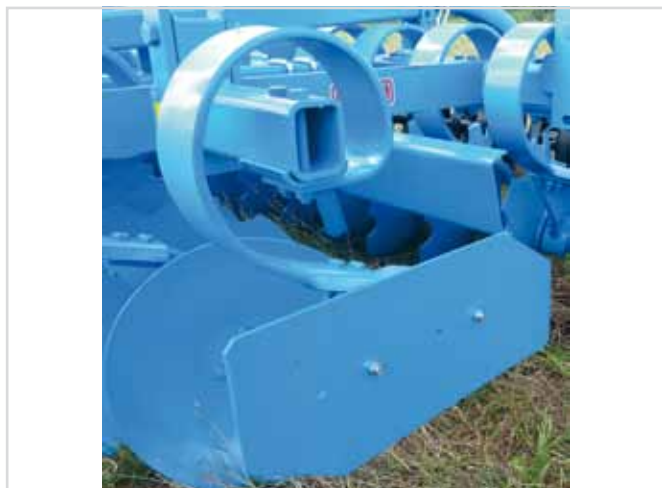
ekrany boczne zaczezione na sprężynie
