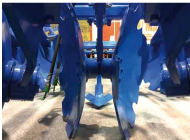
zębata spulchniająca pas środkowy
