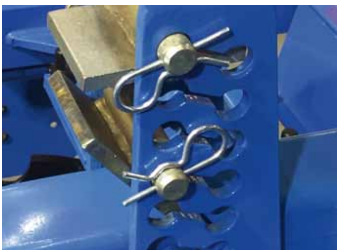
regulacja głębokości pracy na drabinkach
