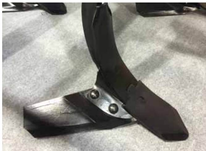
pięcioelementowy system podcinający (szer. podcinania 530 mm)
