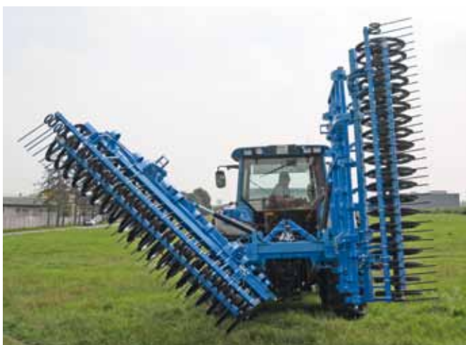
maszyna składana w systemie H
