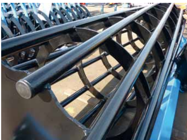
wał rurowy \varnothing 540mm
