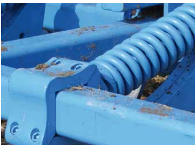
układ roboczy SPEC przykręcony do ramy
