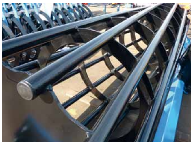
wał rurowy \varnothing 540mm
