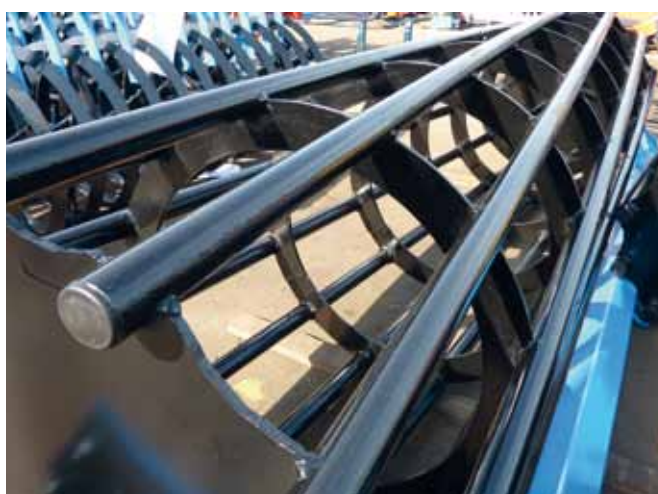
wał rurowy \varnothing 540 mm
