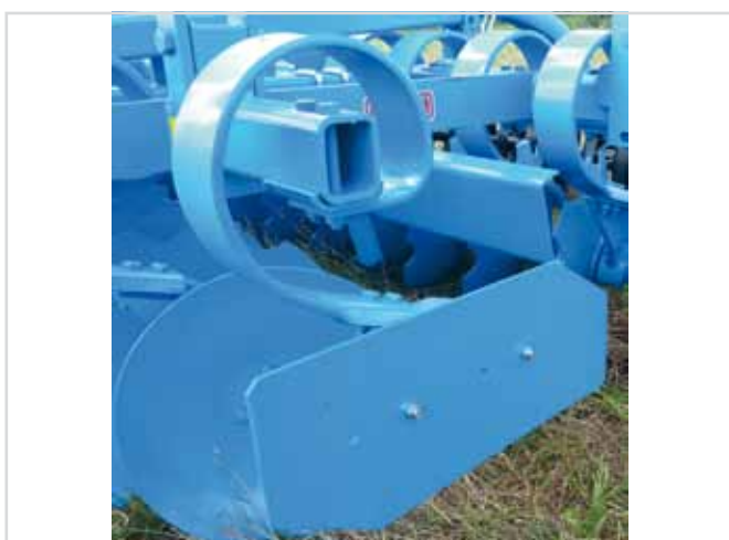
ekrany boczne zaczipione na sprężynie
