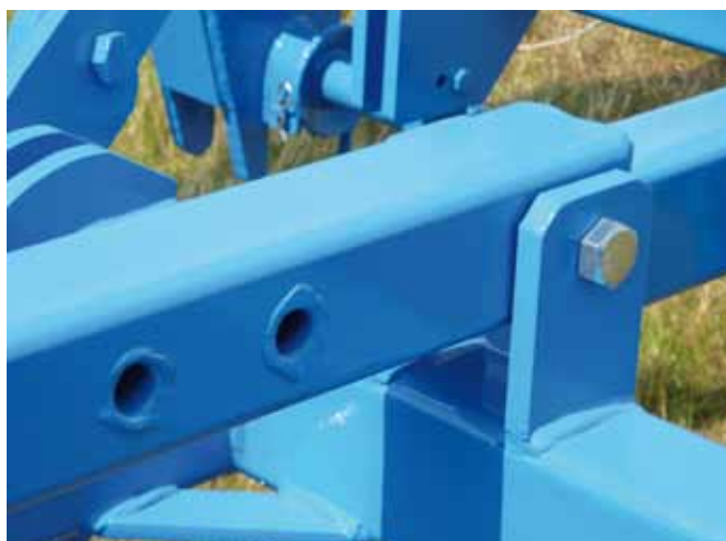
regulacja odległości wału
