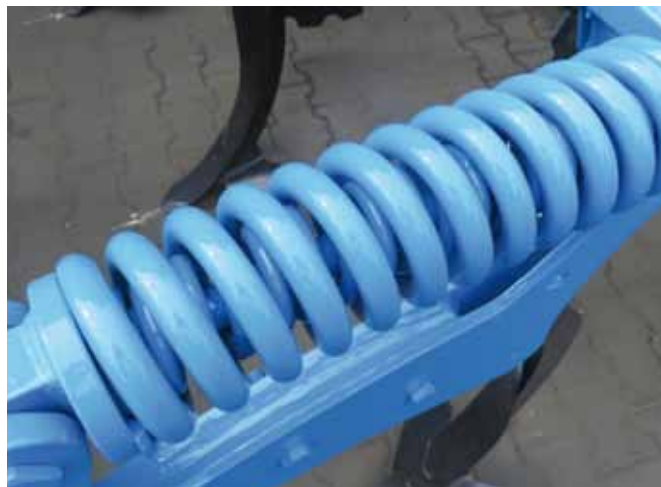
zabezpieczenie podwójnie sprężynowe
