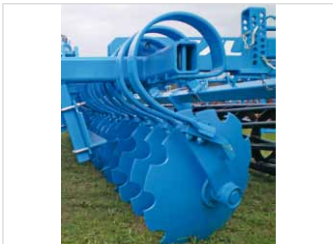
sprężyna amortyzująca 100x13 mm
