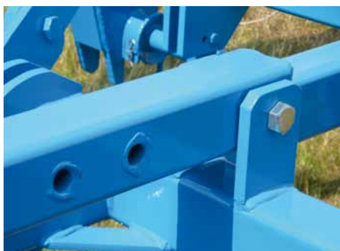
regulacja odległości wału za maszyną
