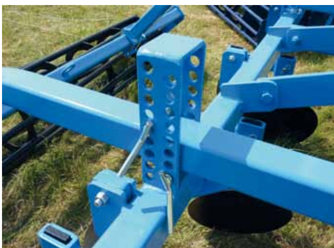
regulacja głębokości pracy na drabinkach
