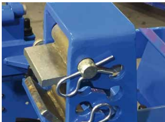
regulacja głębokości pracy na drabinkach
