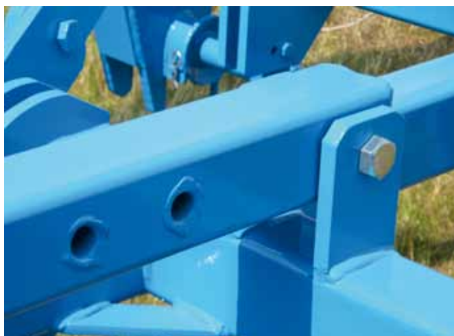
regulacja odległości wału za maszyną
