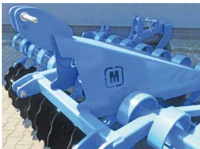
wzmocniony dyszel płaszczowy
