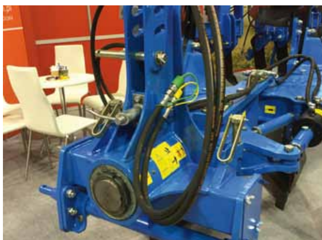
regulacja wysokości belki zaczepowej (kat. III)
