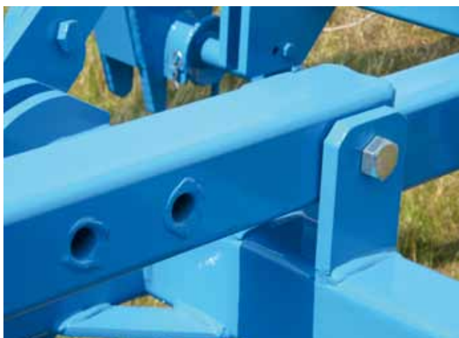
regulacja odległości wału za maszyną
