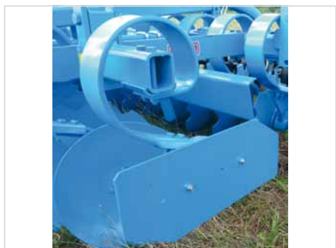
ekrany boczne zaczezione na gumach amortyzujących
