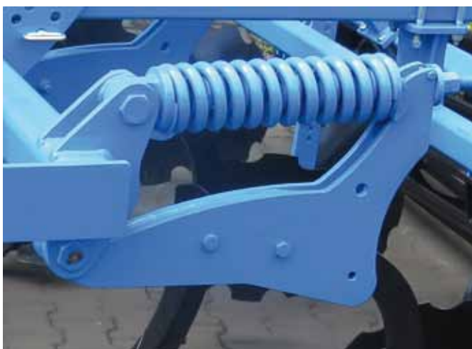
nowy, spawany układ sprężynow
