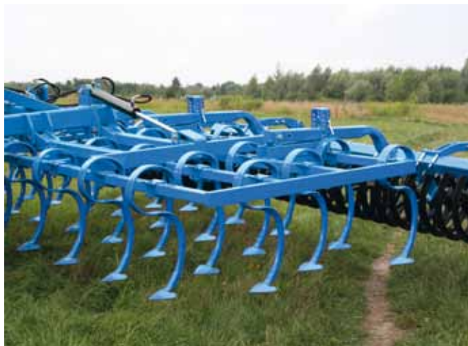
cztery rzędy zębów 70x12 zakończone gęsią stopą
