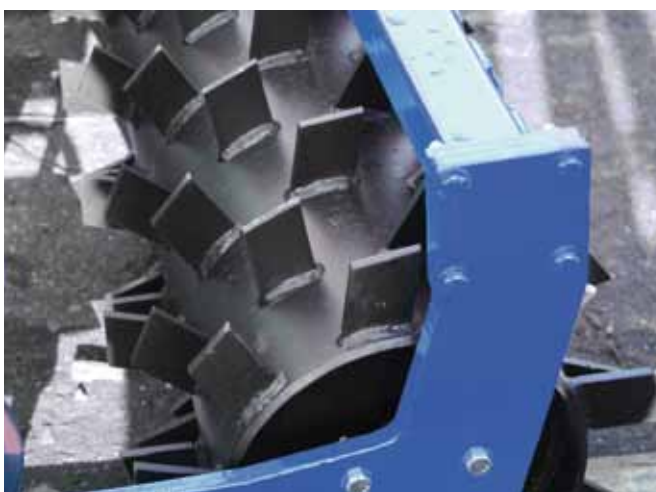
wał packer \varnothing 450mm
