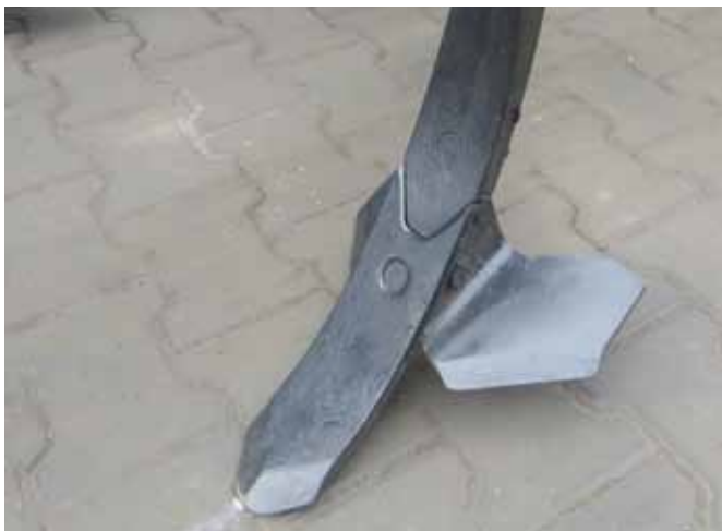
zęb sierpowaty z wysoką odkładnicą (szer. podcinania 270 mm)
