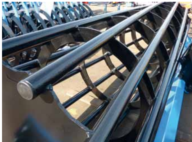
wał rurowy \varnothing 540mm
