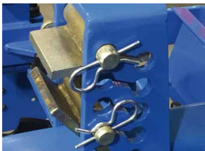
regulacja głębokości pracy na drabinkach
