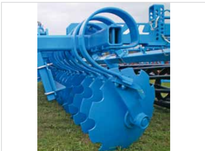
sprężyna amortyzująca 100x13 mm
