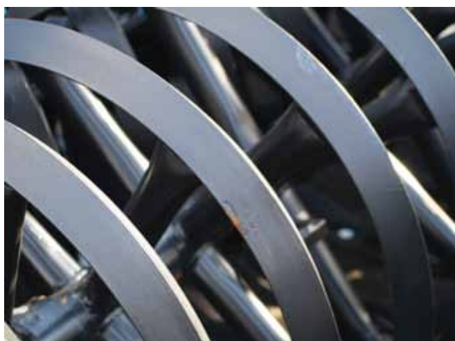
wał daszkowy (V-ring) zagęszczony \varnothing 600 mm
