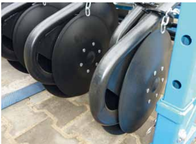
redlice talerzowe samoczyszczące DXD
