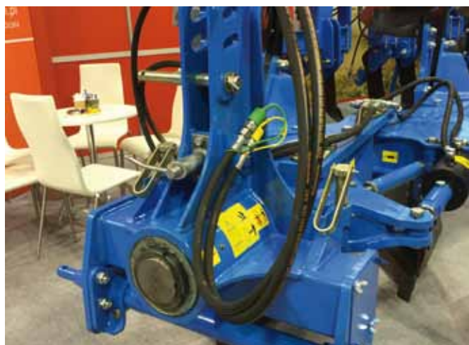
regulacja wysokości belki zaczepowej (kat. III)
