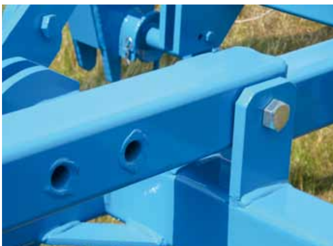
regulacja odległości wału za maszyną (za wyjątkiem GAL-K)
