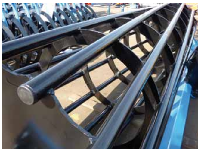
wał rurowy \varnothing 620 mm
