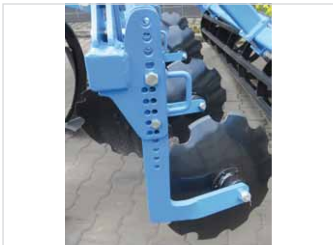
belka z talerzami zawieszona na ramionach wału
