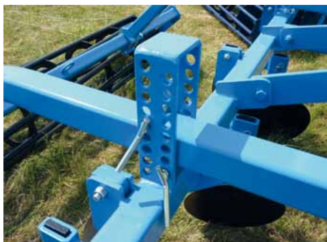
regulacja głębokości pracy na drabinkach
