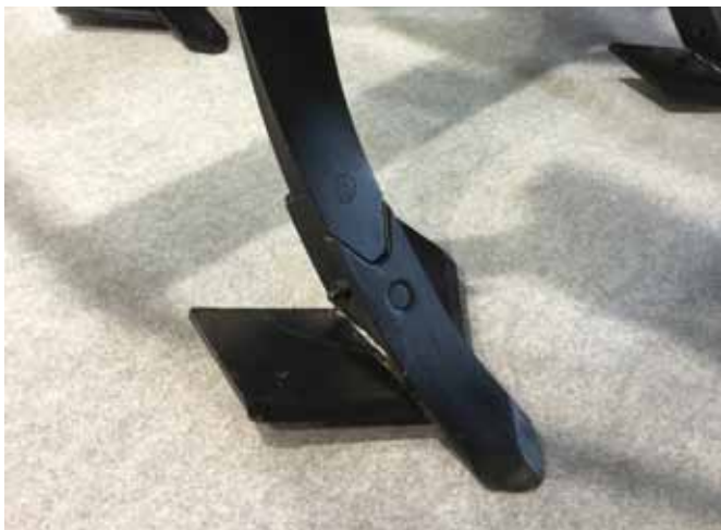
elementy podcinające z wysoką odkładnicą (szer. podcinania 310 mm)
