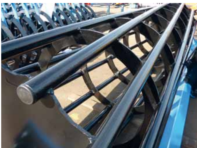
wał rurowy \varnothing 540mm
