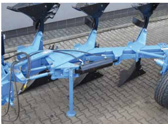
hydrauliczna bezstopniowa regulacja szerokości orki
