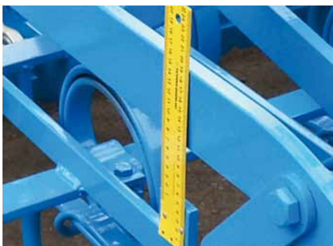
miara wyznaczająca głębokość pracy
