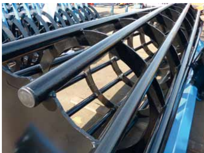
wał rurowy \varnothing 540mm
