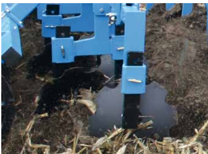
belka z talerzami zawieszona na ramionach wału
