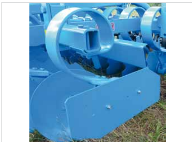
ekrany boczne zaczezione na sprężynie
