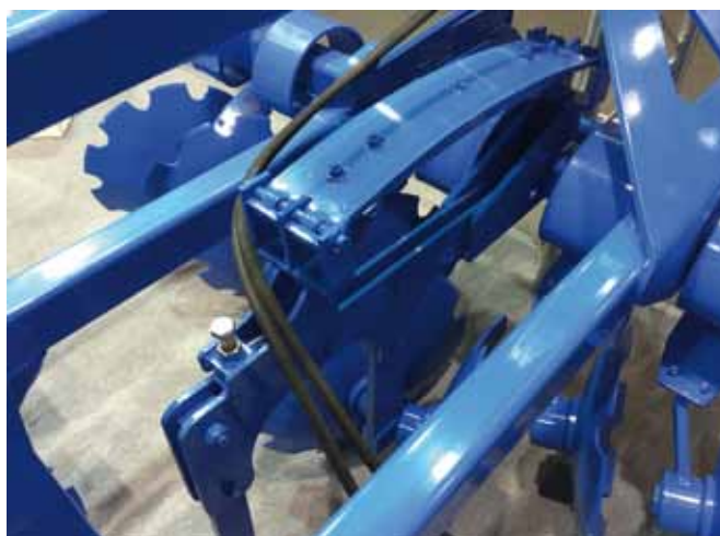
resor zabezpieczający zębata środkowy
