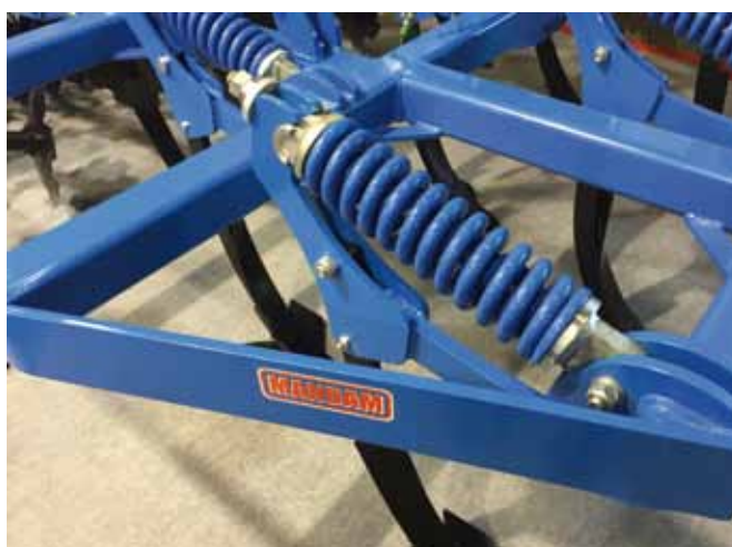
zabezpieczenie sprężynowe (KUS S)
