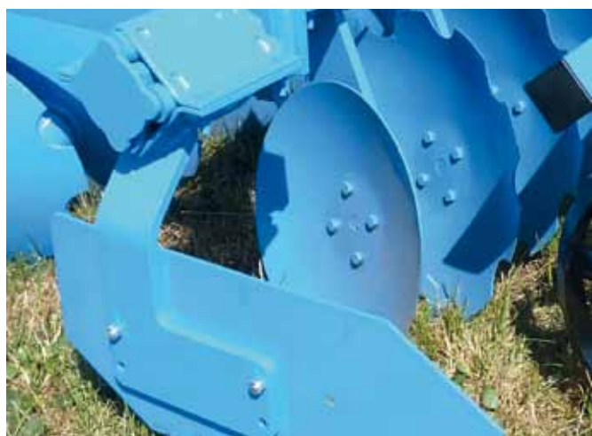
ekrany boczne zaczezione na gumach amortyzujących
