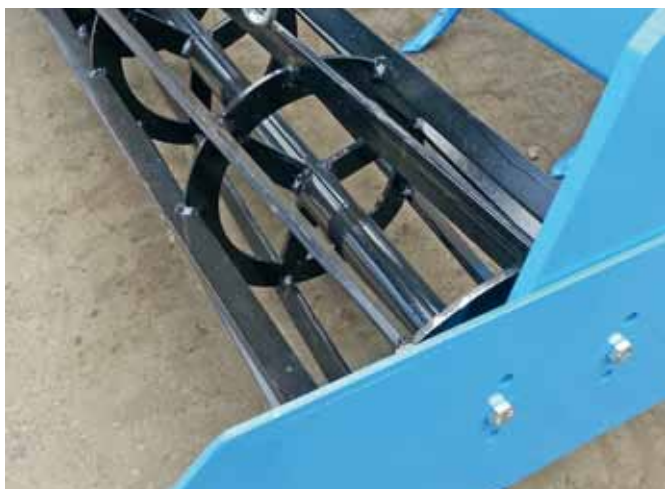
wzmocnione wały płaskownikowe \varnothing 350 mm
