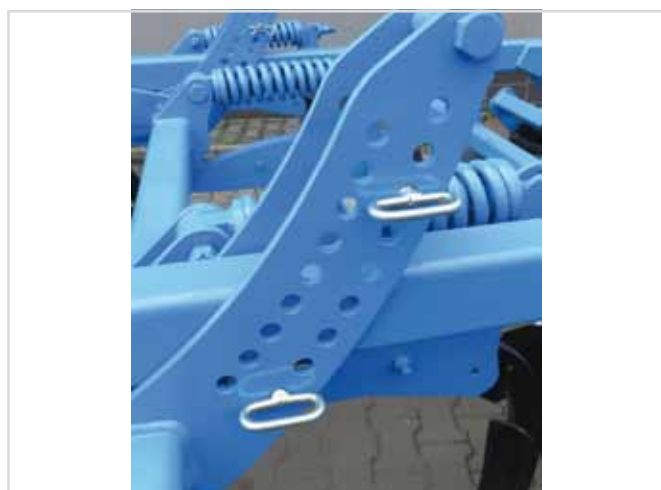
regulacja głębokości pracy na drabinkach
