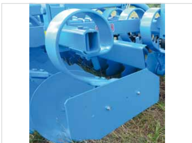
ekrany boczne zaczepione na gumach amortyzujących
