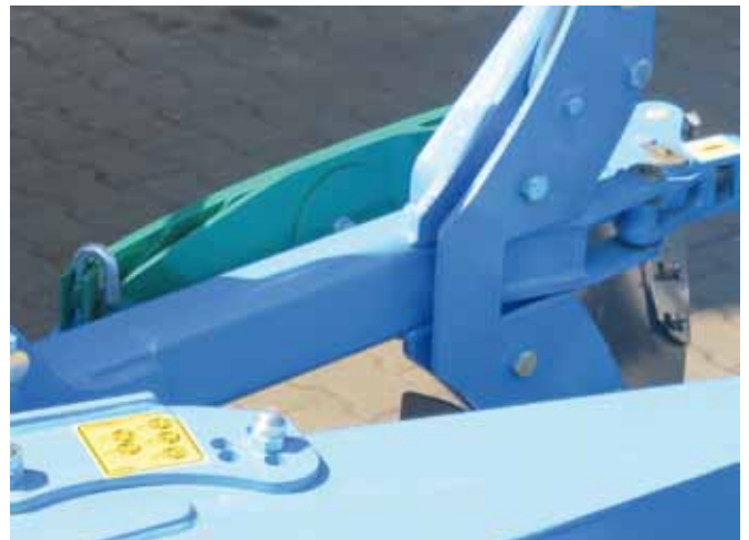
zabezpieczenie resorem 7-piórowym
