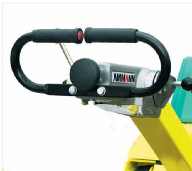
Uchwyt czuwaka z czujnikami elektronicznymi (opcja)
