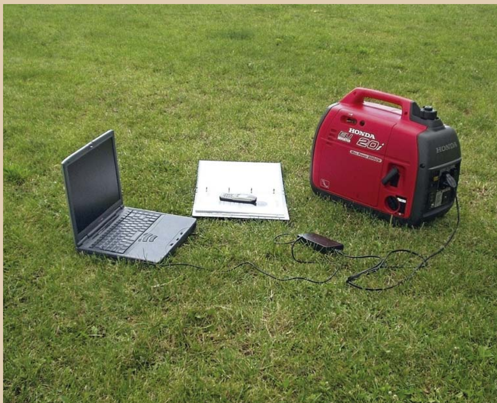
Model EU20i o wadze 20 kg ma dwa gniazda 230 V.
